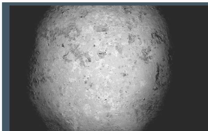
Zwietrzały śrut ołowiany w obrazie mikroskopowym (elektrony wstecznie rozproszone; średnica obiektu ok. 1 mm).
